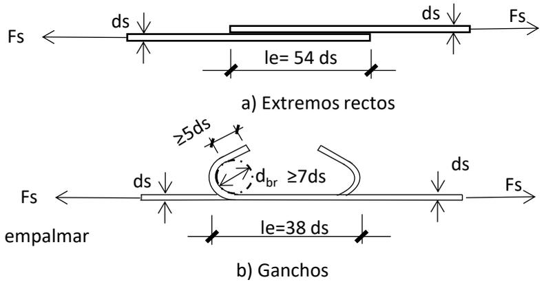
$d_s$ : diámetro de la barra longitudinal a empalmar
