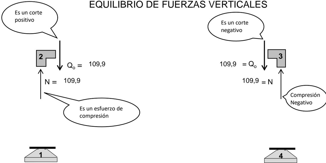
El nudo 2 se equilibra en el sentido vertical con la fuerza resultante en el dintel (esfuerzo de corte) y la fuerza vertical en la columna (esfuerzo normal). Conocemos el valor del corte en el dintel por lo que también conocemos el valor del esfuerzo normal en la columna.
