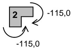
Tanto en la columna (barra 1) que llega al nudo 2 como en el dintel (barra 2) que llega al nudo 2, el momento flector tiene el mismo valor y dibujados gráficamente se ve que se equilibran los sentidos de ambos.
