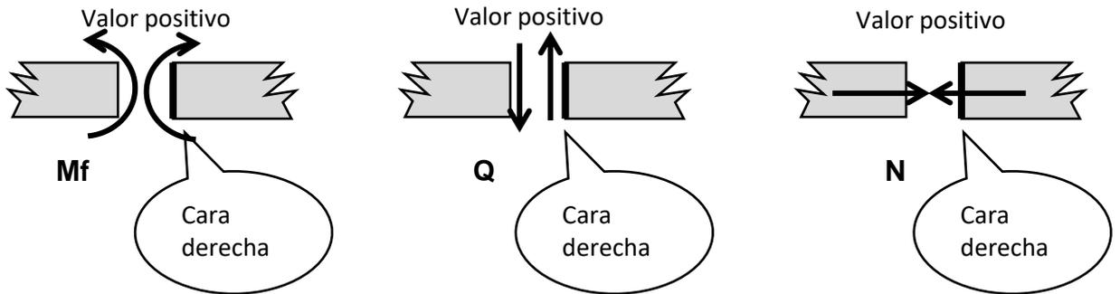
La convención de signos dice que el momento flector positivo tiene sentido horario en la cara derecha de la sección, el esfuerzo de corte positivo tiene sentido hacia arriba en cara derecha y el esfuerzo axil o normal "sale" de la sección cuando el signo es positivo (o sea de tracción).
