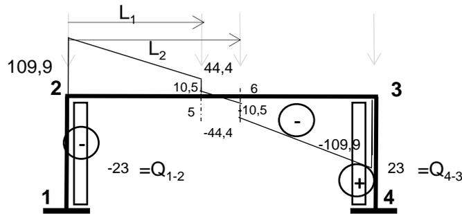
$$Q_{5l} = Q_2 - q \times L_1 = 109,9 - 9,50 \times 6,90 = 44,4 \text{ t} \quad Q_{5D} = 44,4 - 33,9 = 10,5 \text{ t}$$
