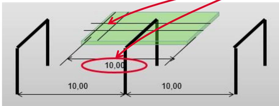
Esquema de carga que recibe un pórtico central:  $800 \text{ kg/m}^2 \times 10 \text{ m} = 8.000 \text{ kg/m}$
