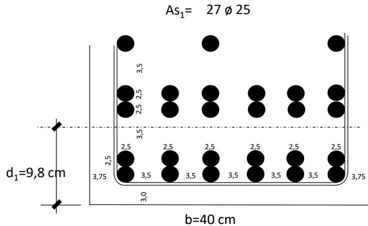
La separación libre entre paquetes de barras rectas paralelas, debe ser como mínimo no inferior al diámetro equivalente dsv. CIRSOC 201-18.11
