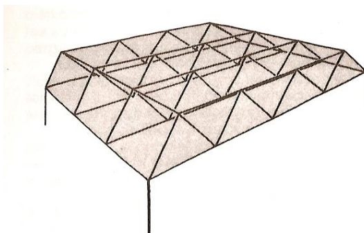
Fig. 9 Armadura con cordones paralelos. Se usan para cubrir grandes luces. Son estructuras livianas.
