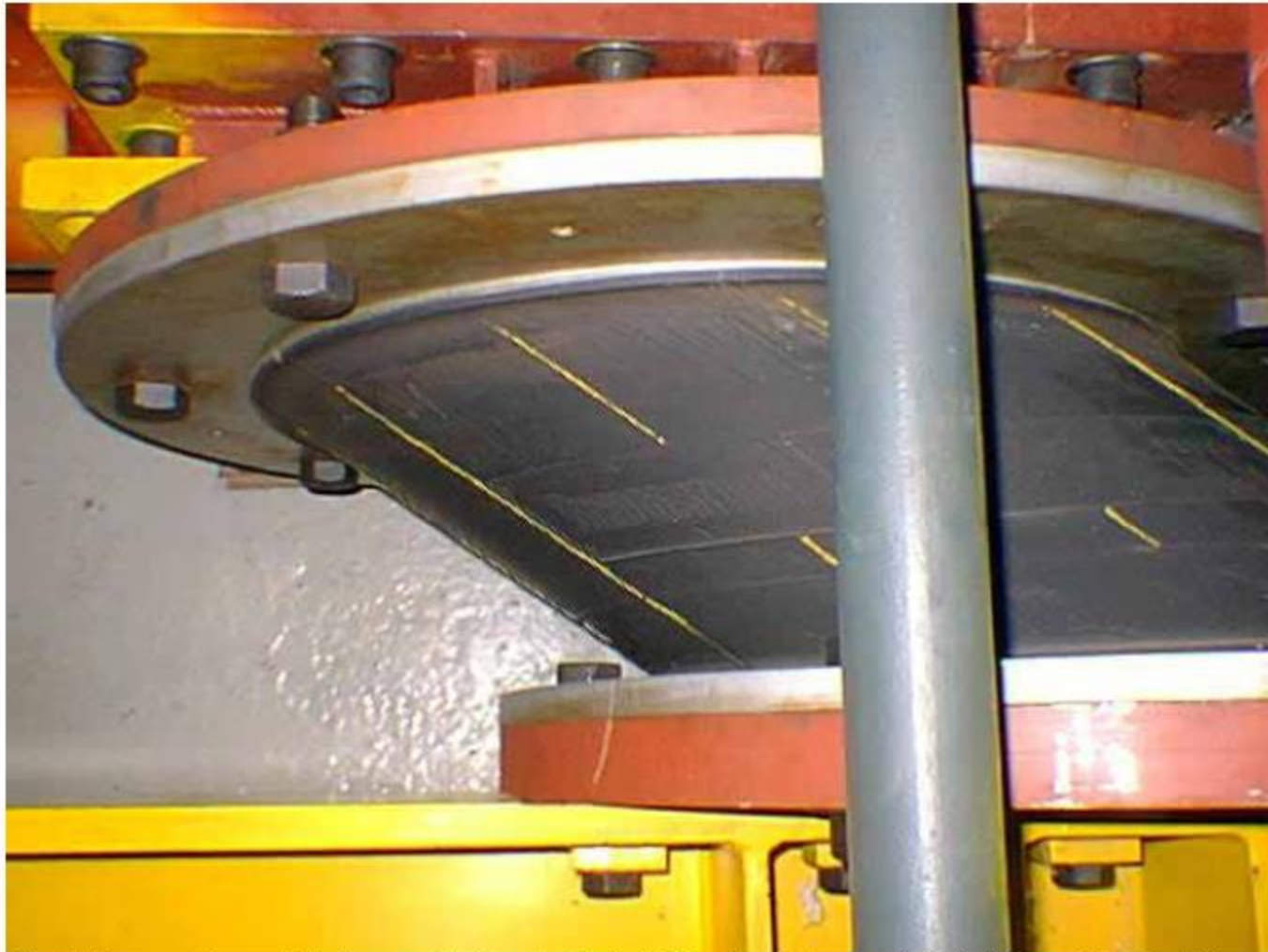
Fig. 5 Ensayo de un Aislador en el Laboratorio de Dinámica Estructural de la Universidad Católica
