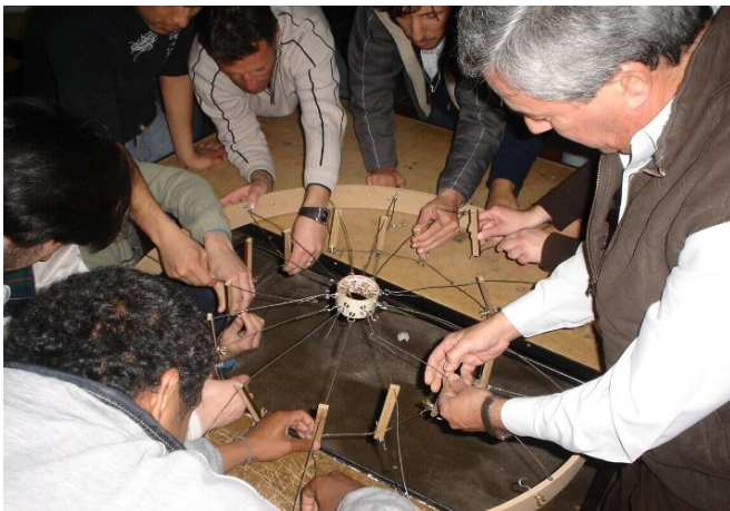
En el armado se pudo experimentar la mayor tensión en el anillo interior, cuyo esfuerzo se denominó en el ejercicio como H3h, y también en el cable inferior (H4). Estos valores resultaron mayores en cinco veces y mayores en dos veces respectivamente, comparados con los esfuerzos en los cables superiores (H1 y H2), que son aproximadamente iguales.
