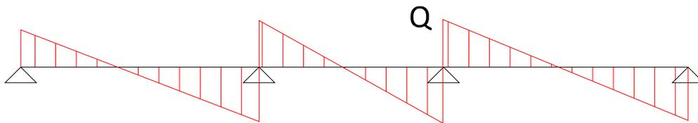
Para calcular el máximo esfuerzo de corte se determina con la máxima luz de la tira de viga.
