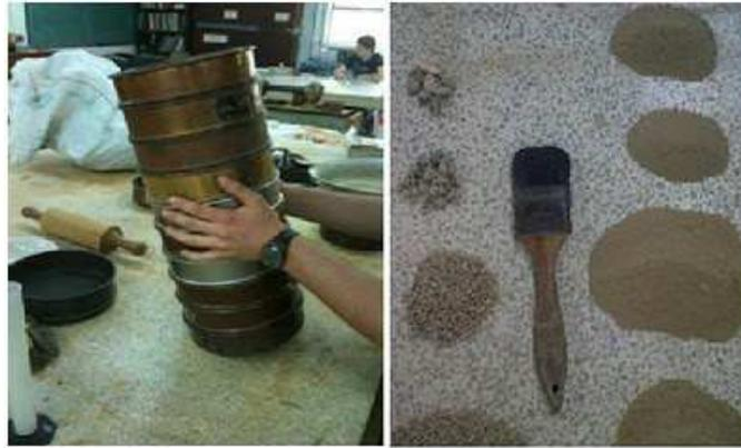
**Fig. 3 Tamices para realizar una Granulometría de un suelo**
