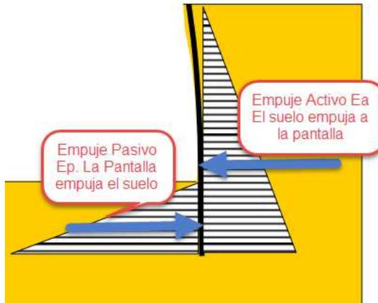
**Figura 21: EMPUJE ACTIVO Y PASIVO DE UN SUELO**
