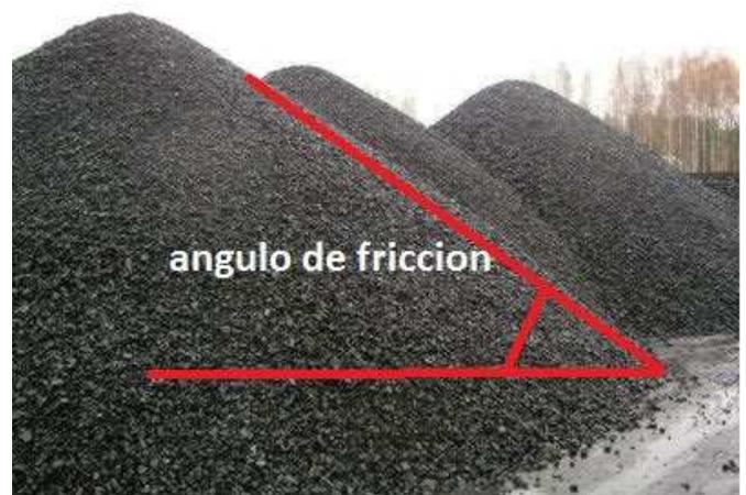
**Fig. 13: Angulo de fricción de un suelo granular**
