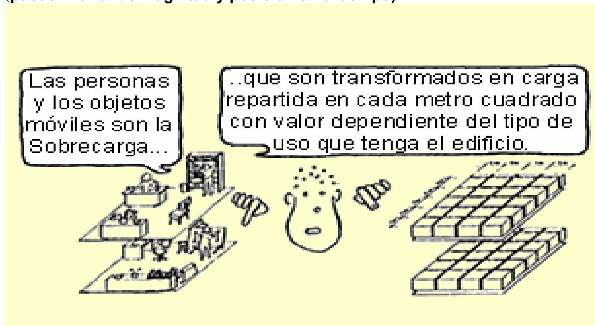
**Las Cargas Variables** son las personas, muebles y otros objetos que cambian en la vida de la estructura. Por lo cambiante de estas cargas, para los cálculos se estiman como una carga repartida por m<sup>2</sup> de superficie estimado según el tipo de Uso del edificio.
