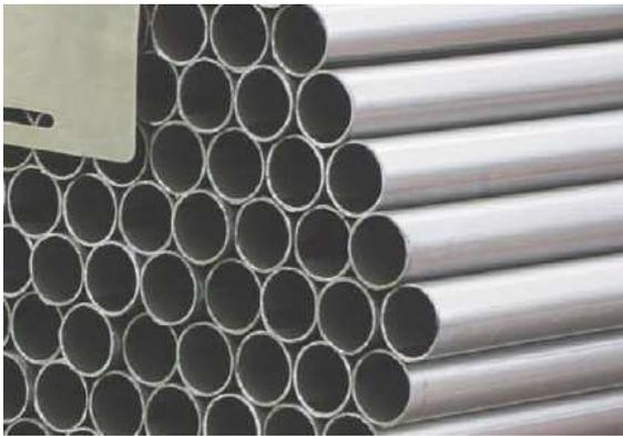
Son secciones cerradas y huecas que forman un tubo que pueden ser de sección circular, rectangular y cuadrada. Hay diferentes formas de fabricación, pueden ser laminados o electro soldados. Como ejemplo de uso estructural se puede mencionar las estereoestructuras donde con secciones circulares a modo de barras se conforma un reticulado espacial apto para cubrir grandes superficies sin apoyos intermedios
