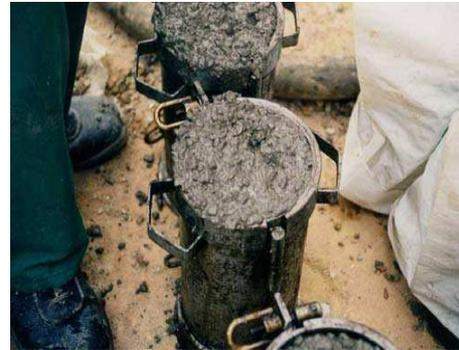
**Moldeo de una probeta de hormigón**
