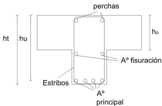
La armadura principal es la encargada de absorber las tracciones producidas por el momento flector (abajo si el momento es positivo, arriba si es negativo). Los estribos son anillos cerrados encargados de tomar el esfuerzo de corte. Las perchas son armadura secundaria donde cuelgan los estribos.
