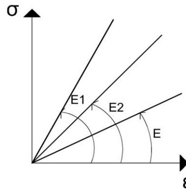
En los materiales que cumplen la ley de Hooke, se observa una proporcionalidad entre las tensiones y deformaciones, ligadas por un parámetro constante denominado modulo de elasticidad E (que depende del material). Entonces el diagrama lineal de deformaciones que menciono en el punto 1.1.2. se transforma en otro de tensiones normales “modificado en escala” por el mencionado modulo de elasticidad E.
