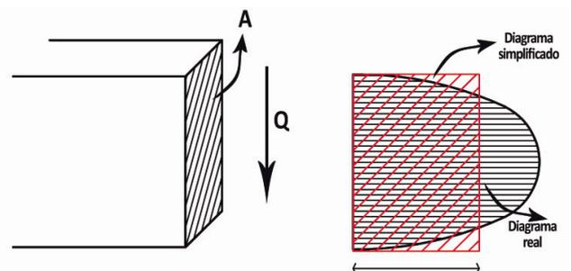
Con un valor máximo en el centro de la sección (no de la viga) igual a:
