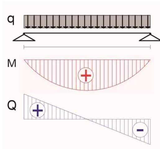
VIGA DE LARGO L Y CARGA Q CON DIAGRAMA DE MOMENTO Y CORTE
