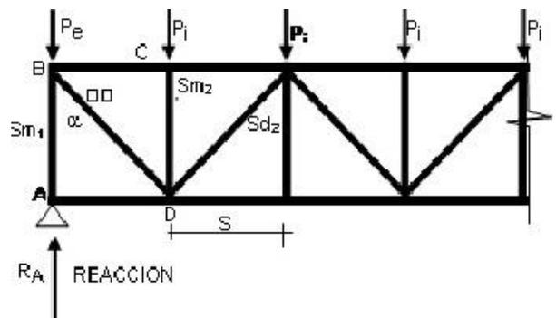
Con los valores obtenidos de m y d (esfuerzos axiles), se dimensionan las correspondientes secciones de las diagonales y montantes  $S_d$  y  $S_m$ .
