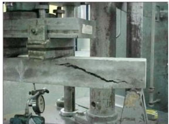
El esfuerzo de corte  $Q$ , provocara tensiones tangenciales  $\zeta_{trab}$  en la sección donde esté actuando. Cada material tiene una capacidad de ofrecer  $\zeta_{adm}$  para contrarrestar este efecto y la rotura por corte entonces se producirá si:
