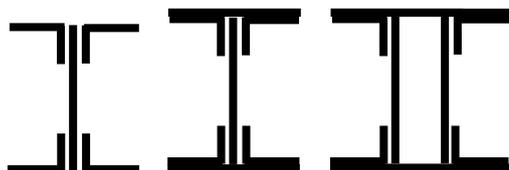
Para el dimensionado de estos perfiles no hay más remedio que proponerlos y verificarlos, es decir armar un determinado perfil, calcular su momento de inercia a través del teorema de Steiner simplificado, es decir que el J de la sección compuesta será:
