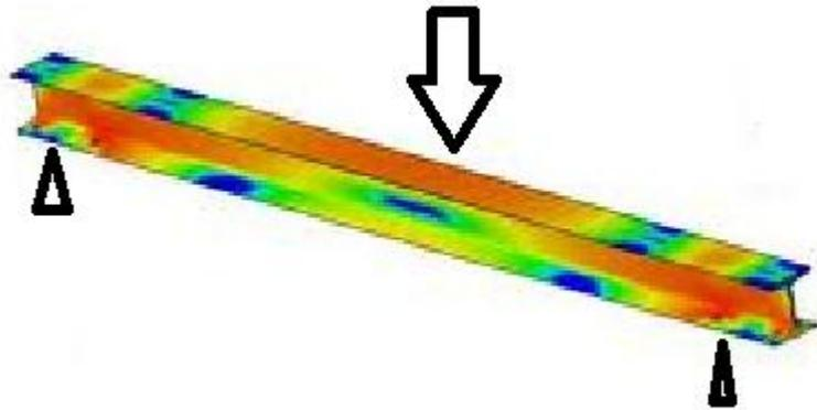
LÍNEA DE ISOTENSIONES DE UNA VIGA SOMETIDA A UNA CARGA PUNTUAL
