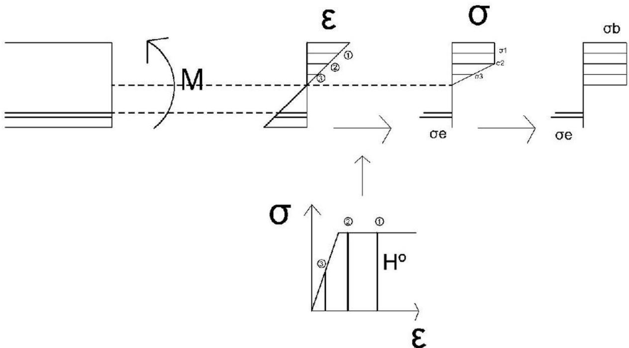
DIAGRAMA DE DEFORMACIONES Y TENSIONES PARA UNA SECCION DE HORMIGON ARMADO SOMETIDA A FLEXION
