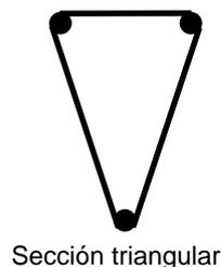
En las barras comprimidas (tanto del cordón comprimido como de alguna de las diagonales o montantes) aparecerá el efecto de pandeo mencionado en el punto. Para minimizar este efecto puede reducirse la distancia entre nudos, lo que disminuye la longitud de las barras y por lo tanto la luz de pandeo).
