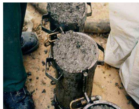
Moldeo de una probeta de hormigón
