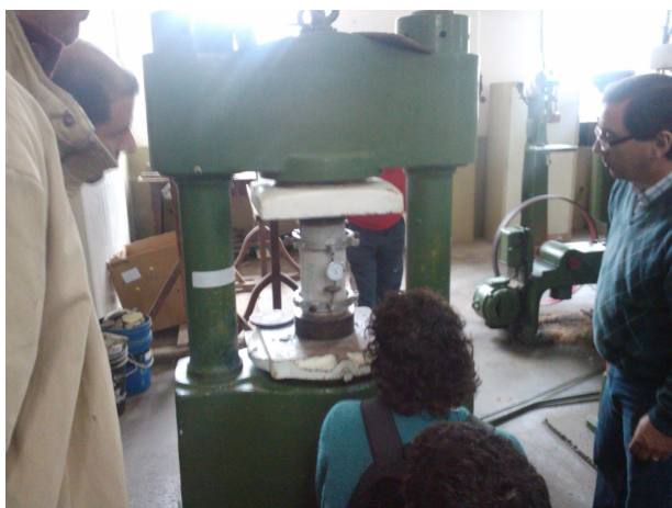
MEDICION DE DEFORMACIONES EN HORMIGON
