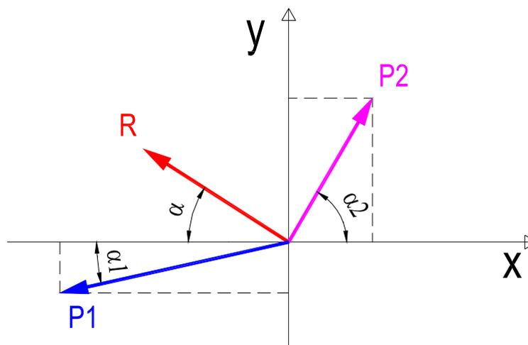
Conocidas las fuerzas componentes del sistema podemos calcular las proyecciones en X y en Y de R (Fuerza Resultante)
