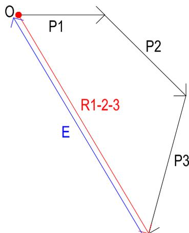
El método del polígono vectorial reemplaza la reiteración del paralelogramo, a partir de un punto O arbitrariamente ubicado. En el plano trazo una paralela a la recta de acción que contiene a P1 y transporto su valor en escala respetando también el sentido sobre esa dirección. Luego por el extremo de P1 trazo la dirección que contiene a P2 reproduciendo su módulo y su sentido. Repitiendo la operación con P3.
