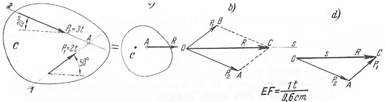
El paralelogramo en una situación simplificada puede ser reemplazado por el diagrama vectorial que es uno de los triángulos que conforman el paralelogramo.
