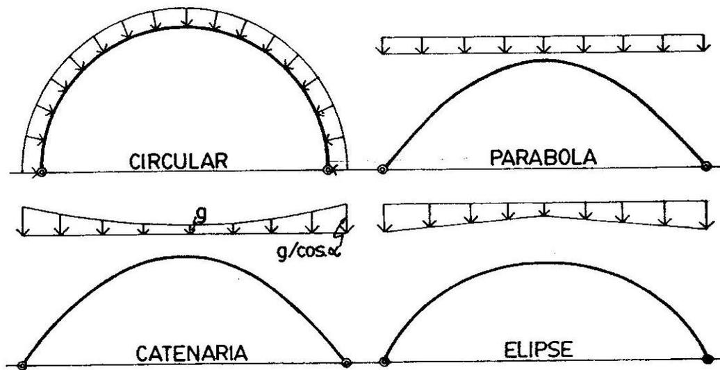
La construcción de estructuras cuyo eje responda en su geometría al antifunicular de las cargas, generara construcciones en las cuales si logramos mantener el estado de cargas original tendremos una estructura sometida a esfuerzos de un solo signo.
