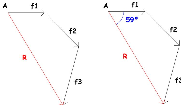
c- Midiendo la longitud de la resultante se obtiene su módulo y midiendo con transportador el ángulo  $\alpha$  R. Para este caso: 8,8cm - 59°
