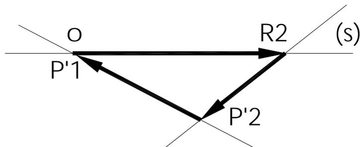
Tendrá validez la operación inversa, donde dada una fuerza la misma podrá descomponerse en dos direcciones que se establezcan, obteniéndose así un sistema de dos fuerzas equivalente al original.
